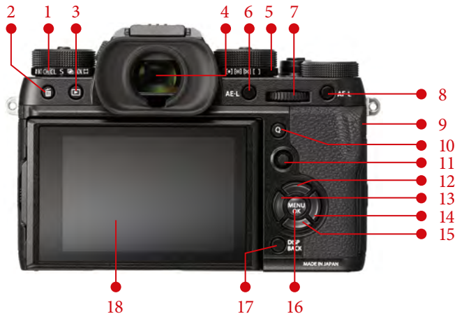
Рис. 3. Камера X-T2, вид сзади: диск режимов затвора (1), кнопка удаления (2), кнопка просмотра изображений (3), видоискатель (4), диск режимов экспозамера (5), кнопка AE-L / кнопка Fn (6), задний диск управления с функцией нажатия (7), кнопка AF-L / кнопка Fn (8), индикатор состояния (9), кнопка Q – меню быстрого доступа (10), джойстик фокусировки с функцией нажатия (11), верхняя клавиша навипада / кнопка Fn (12), левая клавиша навипада / кнопка Fn (13), правая клавиша навипада / кнопка Fn (14), нижняя клавиша навипада / кнопка Fn (15), кнопка MENU/OK (16), кнопка DISP/BACK – дисплей/назад (17), ЖК-дисплей (18)
